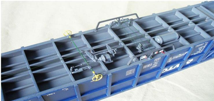
Weiter werden noch die Bremsgestänge montiert, (zwischen die Bremshebel und die Drehzapfen von den Drehstellen).
