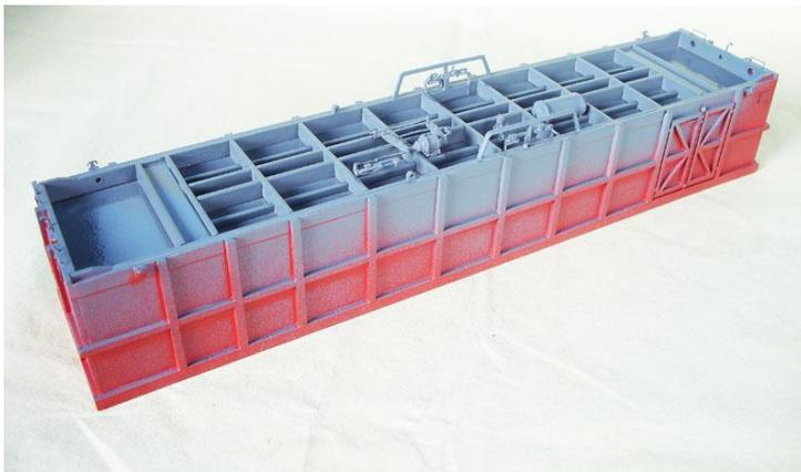
Nach abkleben von die Boden wird das Gehäuse (nur Außen) in Signalblau (VTG Hausfarbe) lackiert (Ral 5005).
