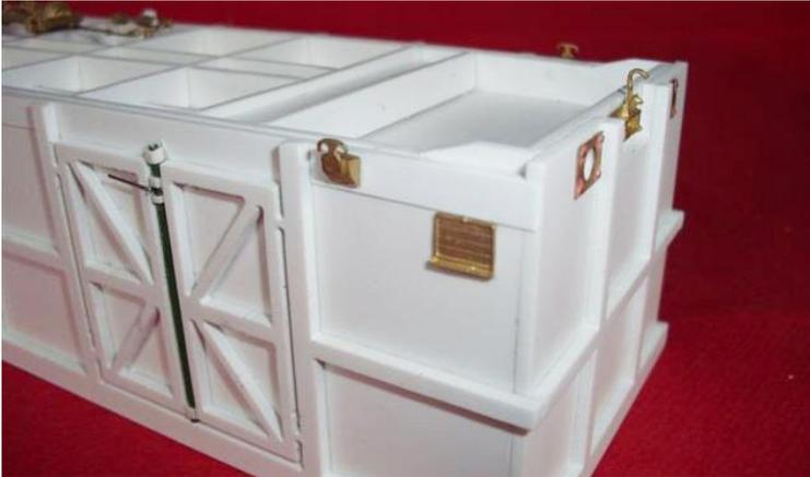
Splinte werden überzogen mit ein Stück Kunststoffdraht und verwendet als Halter für die Entlüftungsgestänge und Quer ausgerichtet mit dem Entlüftungsventil.
