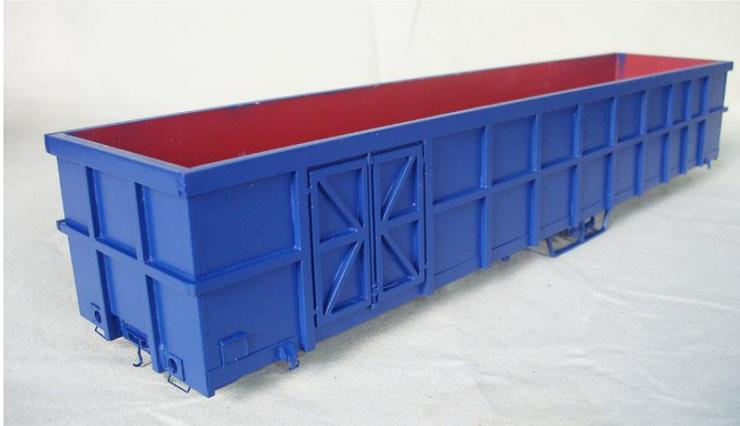
Details wie Handgriffe, Brems- / Lastschalter Gestänge und die Entlüftungsgestänge werden angefertigt aus Draht (0,6 mm)
