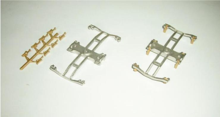
Die Drehgestelle werden vormontiert zum Probelauf, grundiert und lackiert (Ral 9011).
