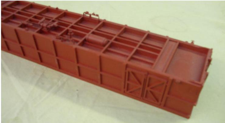
Nach der Einbau von Schütz bügel aus 1.5 mm Draht wird die Unterseite Basaltgrau angestrichen (Ral 7012).
